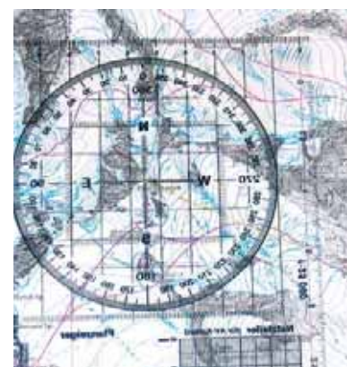
13 Přenos naměřeného azimutu na mapu plánovací fólie
