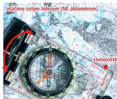
12 Přenos naměřeného azimutu na mapu buzolou
