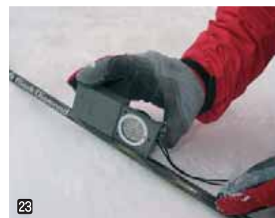
23 Měření sklonu svahu
